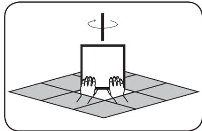
5 Obróć panel LED tak by umożliwić umieszczenie w strukturze sufitu. / Rotate the Panel to insert easily in to the ceiling grid. / Drehen Sie das LED-Panel, damit es problemlos in die Deckenstruktur eingefügt werden kann.
