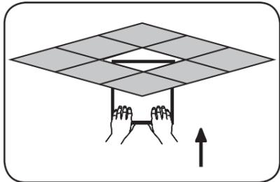
4 Umieść panel LED w suficie podwieszanym. / Insert the LED Panel in the ceiling grid. / Platzieren Sie das LED-Panel in dem Deckenraster.
