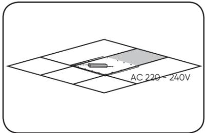
10 Podłącz zasilacz LED do sieci z prądem zmiennym, włącz zasilanie układu elektrycznego. / Connect the LED Driver to AC mains power, turn on the power to the electrical system. / Schließen Sie das LED-Netzteil an das Wechselstromnetz an, Schalten Sie die Stromversorgung des elektrischen Systems ein.
