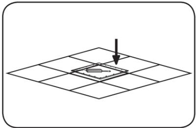
7 Upewnij się, że panel został umieszczony równo w strukturze sufitu. / Ensure the Panel sits evenly inside of the T-bar ceiling grid. / Stellen Sie sicher, dass das Panel gleichmäßig im T-Bar-Deckenraster angebracht ist.
