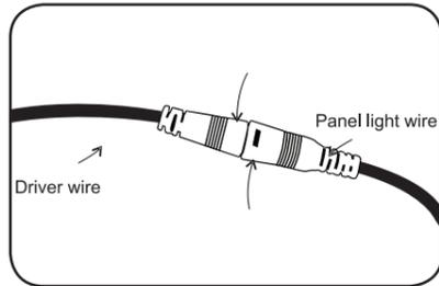
1 Podłącz przewód do gniazda prądu stałego na zasilaczu. / Connect the LED Panel cable to the DC side of the LED Driver.
