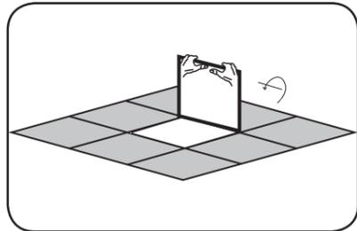
6 Umieść panel LED w strukturze sufitu. / Place the LED Panel in the line with the ceiling grid. / Platzieren Sie das LED-Panel in der Deckenkonstruktion.
