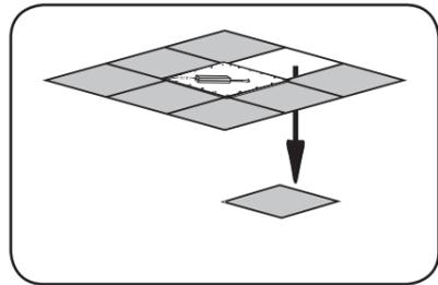
8 Wyjmij panel sufitu obok panelu LED. / Remove a ceiling panel next to the LED Panel. / Entfernen Sie eine Deckenverkleidung neben dem LED-Panel.
