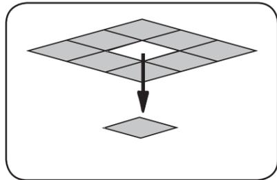
3 Zdejmij standardowy panel z sufitu podwieszanego. / Remove the ceiling grid panel. / Entfernen Sie das Panel von der abgehängten Decke.
