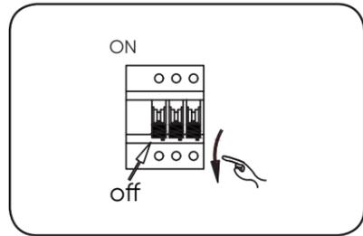
9 Przed podłączeniem panelu, odłącz zasilanie układu elektrycznego. / Before connecting the panel, disconnect the power supply to the electrical system. / Trennen Sie vor dem Anschließen des Panels die Stromversorgung zum elektrischen System.
